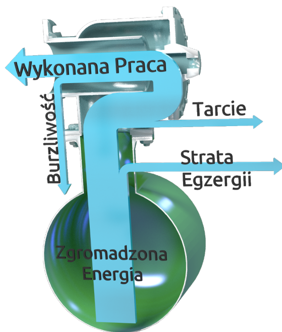
Rys. 8: Rozkład strat energii w pulsatorze pneumatycznym.
