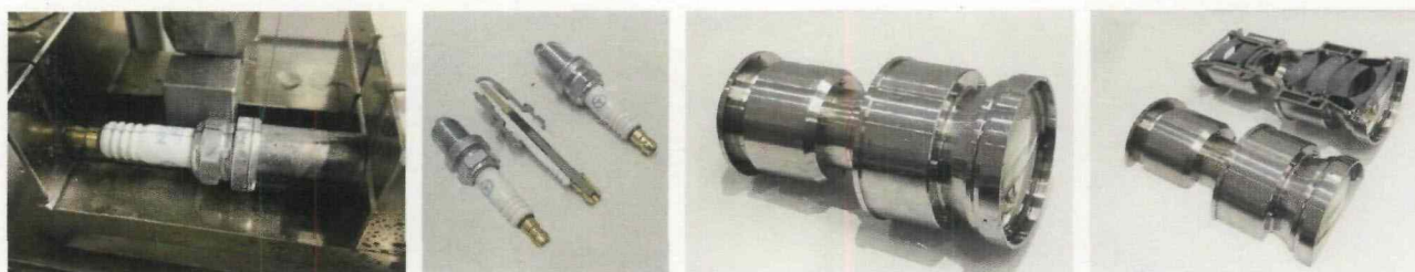
Fot. 7. Wybrane przykłady detali przecinanych struną diamentową [17]
