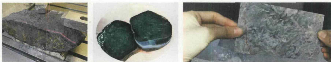
Fot. 6. Przykład zastosowania strun diamentowych w procesie przecinania meteorytu oraz kamieni naturalnych: jadeitu i granitu [14, 17]
