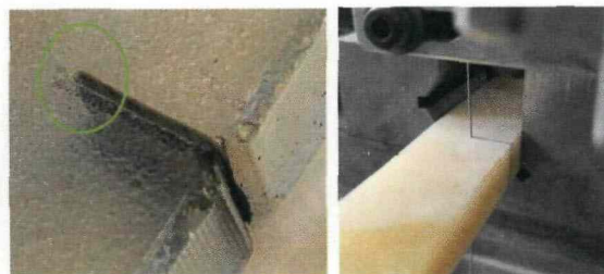
Fot. 9. Przykłady próbek z karbem wykonanym metodą przecinania struną diamentową
