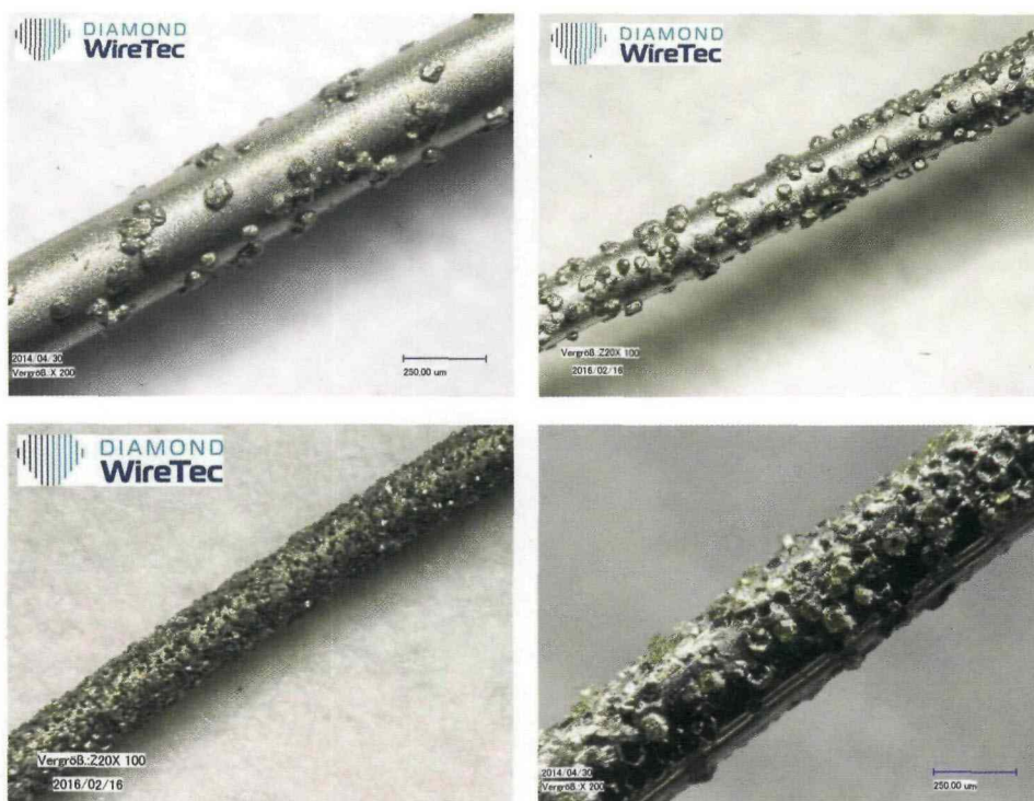
Fot. 4. Przykładowe topografie strun zbrojonych trwale w ziarno diamentowe, wytwarzanych przez firmę Diamond WireTec [17]
